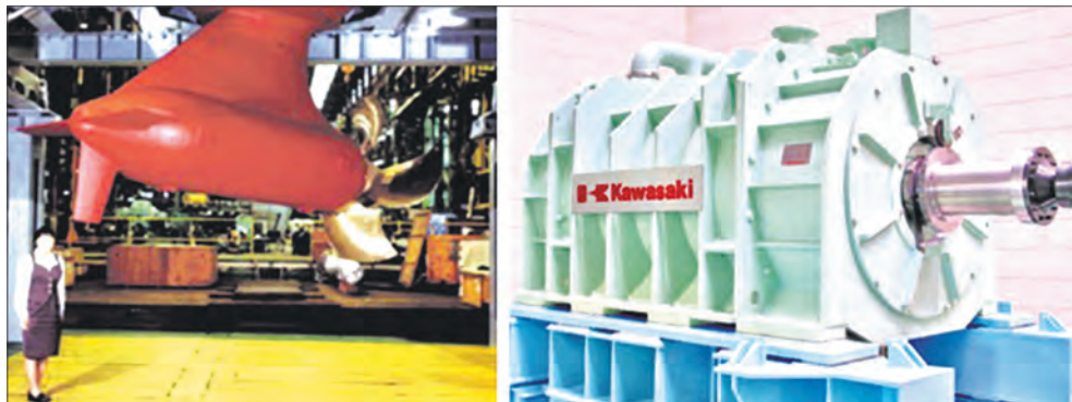
Процесс установки электродвигателя на ВТСП мощностью 1 МВт (слева) и внешний вид электродвигателя на ВТСП мощностью 3 МВт компании «Кавасаки» (справа)
