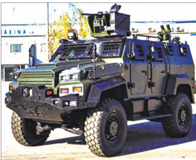
На вооружении венгерских сухопутных войск состоят турецкие ББМ «Гидран», оснащенные дистанционно управляемым модулем вооружения с 12,7-мм пулеметом. Мощность дизельного двигателя 375 л. с.
