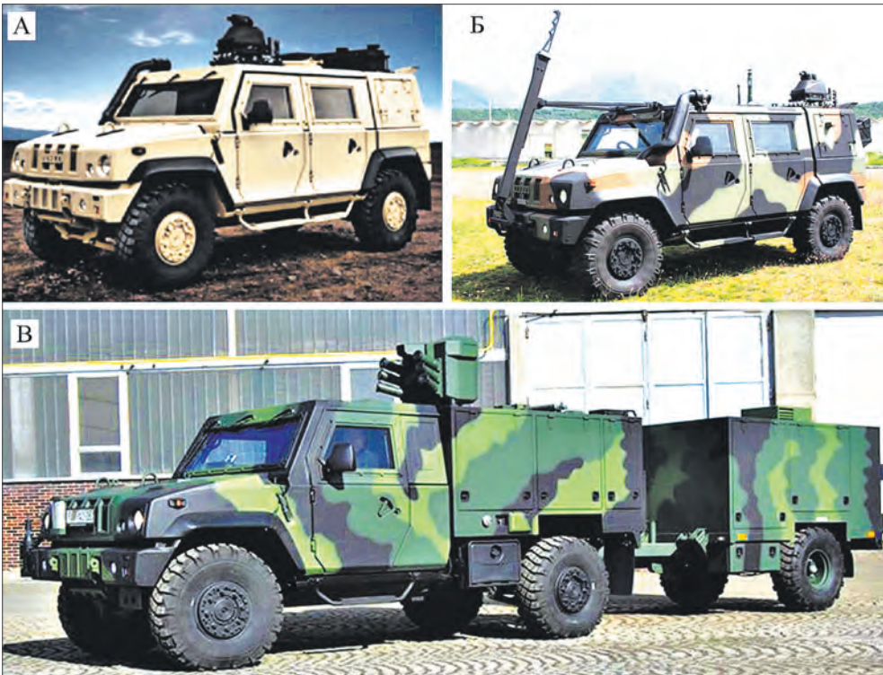
Машины РХБ-разведки на базе бронированного автомобиля LMV M65 «Ивеко»: А) «Сааб»; Б) «Рсса»; В) «С-Лов»
