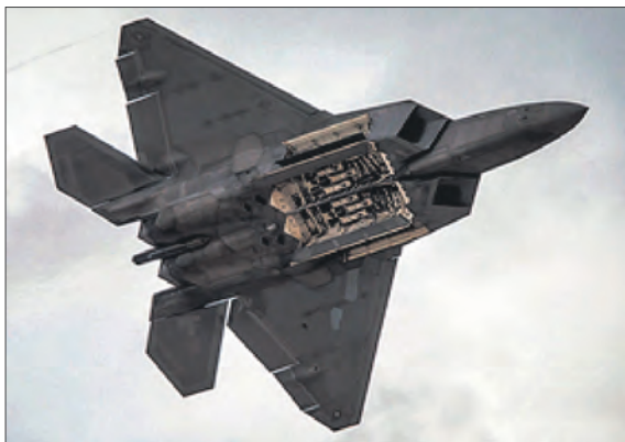
Отсеки вооружения истребителя F-22A «Раптор»
